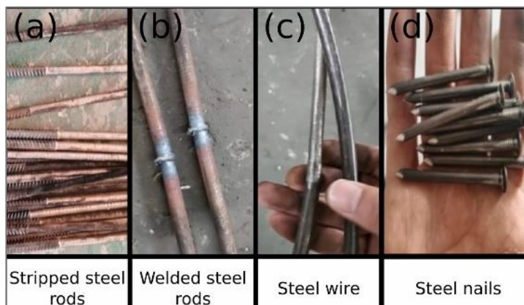
Рис. 4. Фотографии отходов арматуры после различных этапов процесса восстановления: а – зачищенные стальные стержни после зачистки ребер; б – сваренные стальные стержни после сварки встык; в – стальная проволока после уменьшения диаметра; г – конечный продукт в виде стального гвоздя [20]
