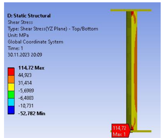
Рис. 6. Максимальные значения касательных напряжений \tau_s в опорном сечении Fig. 6. Maximum tangent values stress \tau_s in the support section
