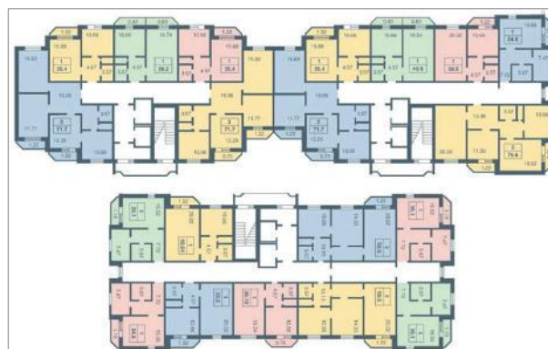
Рис. 2. Планировки квартир в домах 137 серии 2 Fig. 2. Layouts of apartments in houses of series 137
