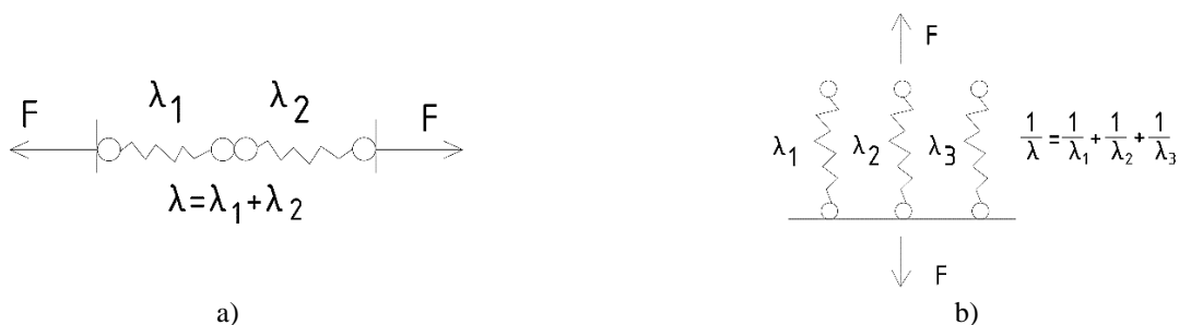
Рис. 3. Случаи расположения элементов стыка: а – последовательное; б – параллельное Fig. 3. Cases of arrangement of joint elements: a – serial; b – parallel
