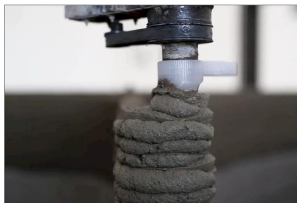
Рис. 6. Мелкозернистая бетонная смесь. Печать на 3D-принтере 2 Fig. 6. Fine-grained concrete mix. 3D printing
