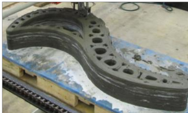
Рис. 1. Бетонная печать [12] Fig. 1. Concrete printing
