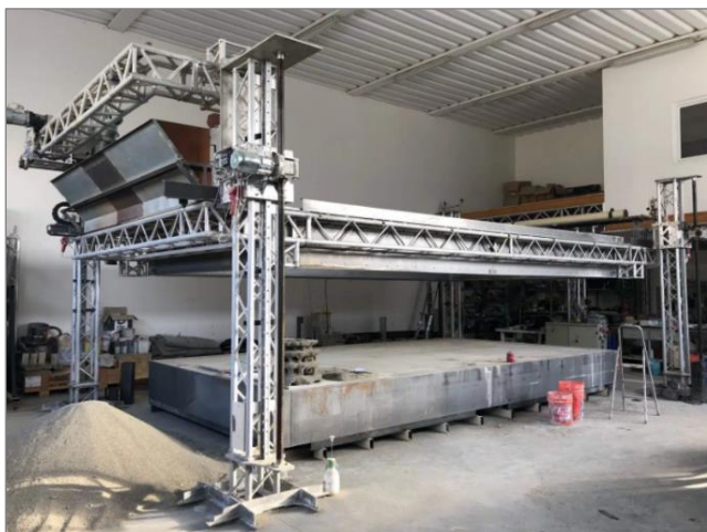
Рис. 3. Принтер D-Shape 1 Fig. 3. D-Shape Printer
