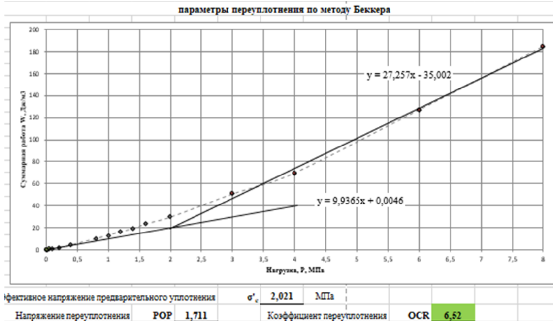
Рис. 2. Определение значения коэффициента переуплотнения по методу Беккера Fig. 2. Determination of the value of the OCR coefficient by the Becker method
