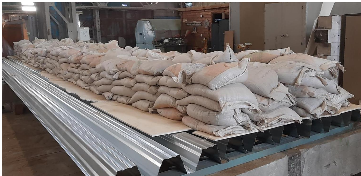
Рис. 1. Испытательный образец при определении несущей способности профилированного настила компании «ЛИНО» (Россия)
