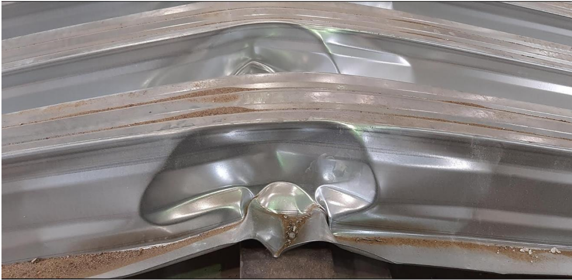
Рис. 2. Испытательный образец после локальной потери устойчивости на опоре Fig. 2. Test sample after local loss of stability on the support
