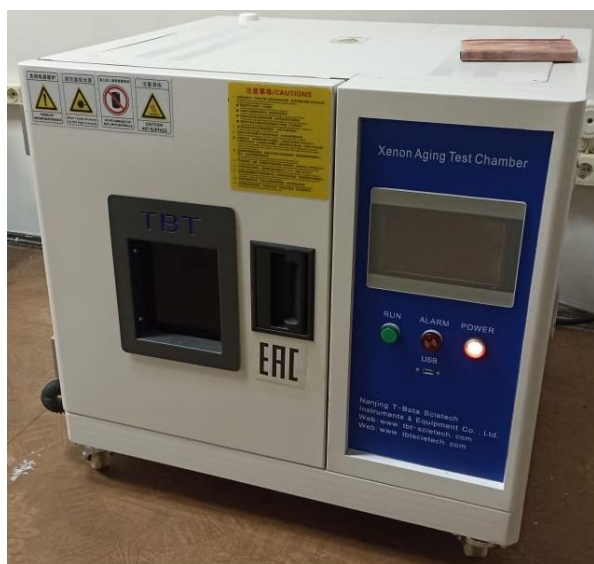
Рис. 3. Камера для испытаний на старение Fig. 3. Xenon Lamp Aging Test Chamber
