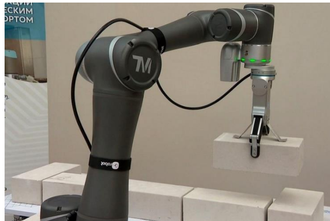
Рис.7. Робот-каменщик из БрГТУ 7 Fig. 7. Robot mason from BrGTU
