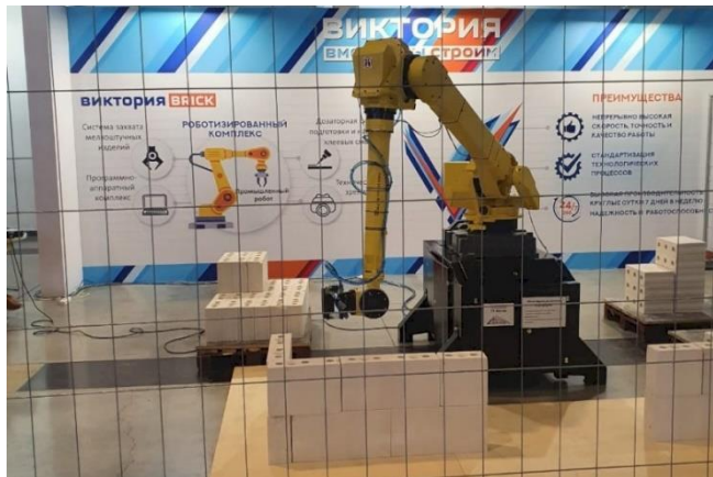
Рис.6. Робот-каменщик «Виктория BRICK» 6 Fig. 6. Robot mason "Victoria BRICK"
