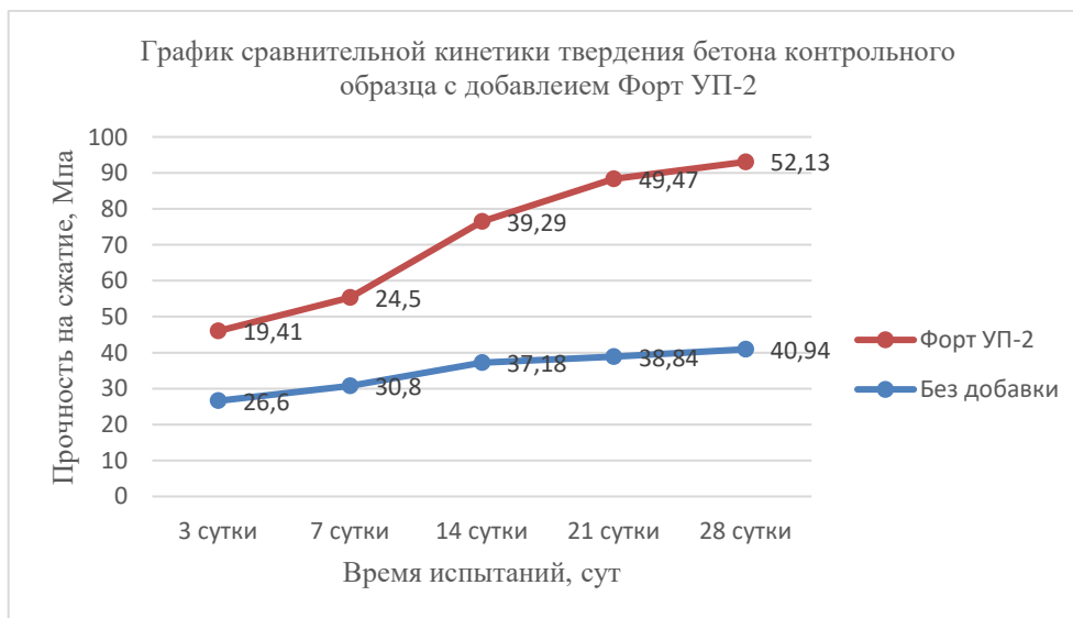
Рис. 6. График сравнительной кинетики твердения бетона контрольного образца с добавлением Форт УП-2 Fig. 6. Graph of the comparative kinetics of hardening of the concrete of the control sample with the addition of Fort UP-2
