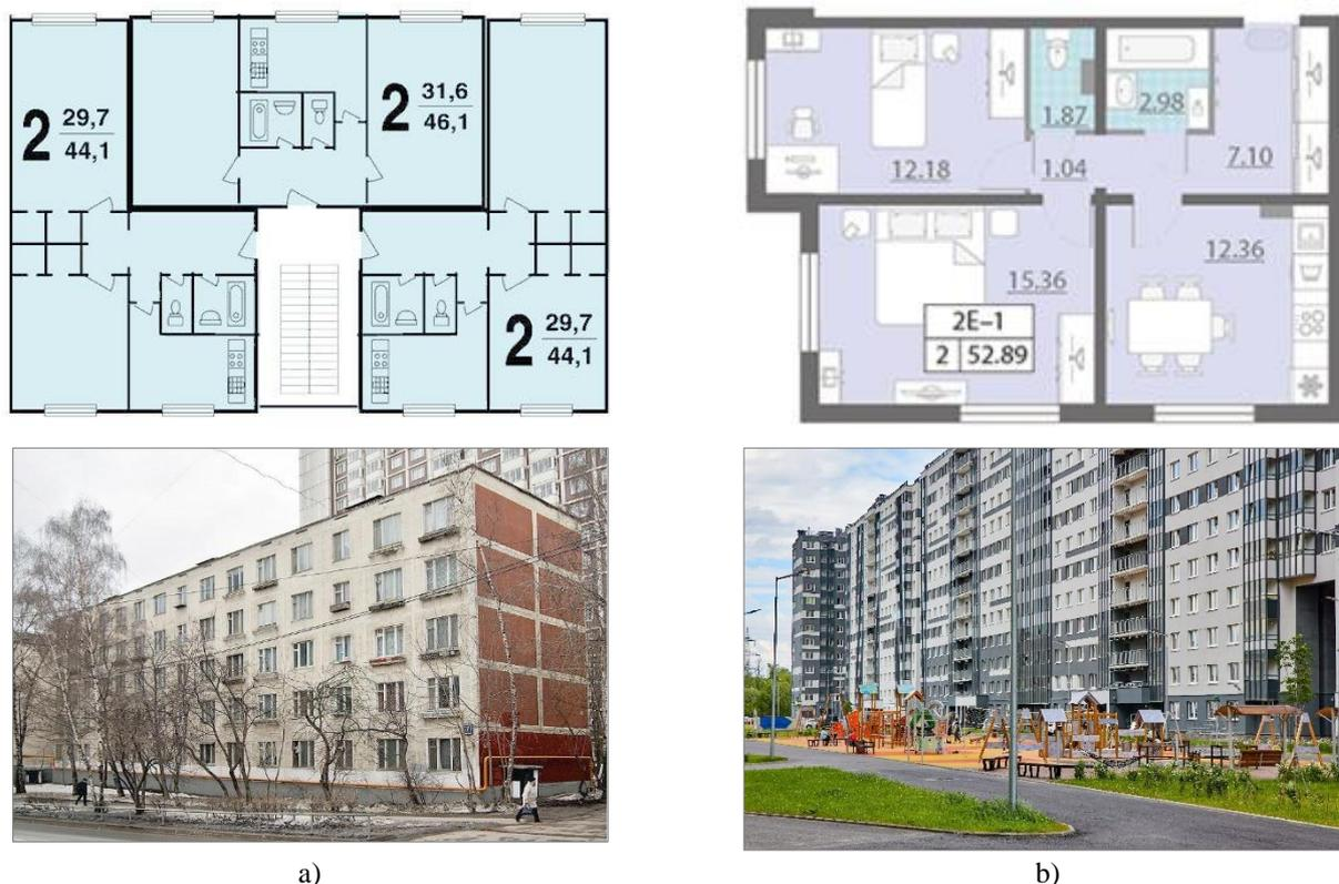
**Рис. 8.** Планировки квартир панельных домов: а – Дом серии К-7<sup>7</sup>; б – ЖК «Ручьи» в Санкт-Петербурге<sup>8</sup>
