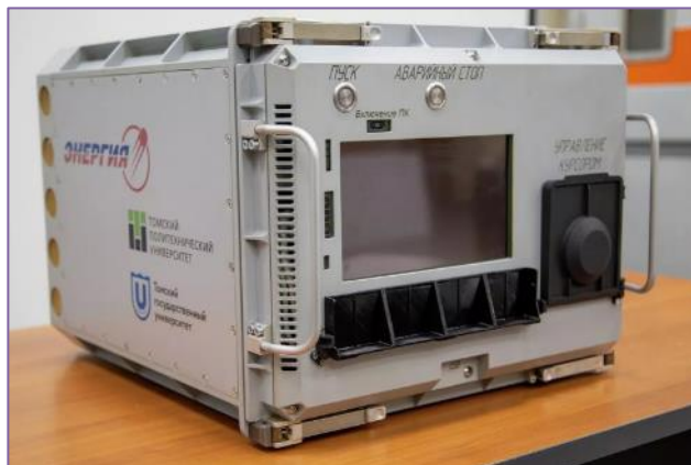
Рис. 2. Первый российский 3D-принтер для работы в космосе [7] Fig. 2. The first Russian 3D printer to work in space
