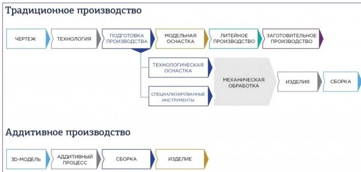
Рис. 4. Процессы, ведущие к готовому продукту 3 Fig. 4. Processes leading to the finished product
