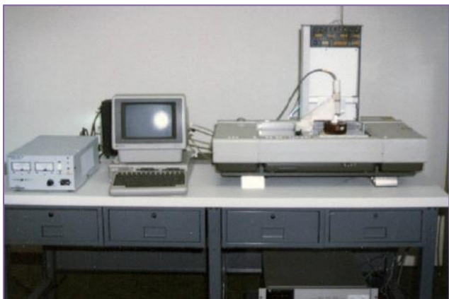
Рис. 1. Первый 3D-принтер SLA-1 1 Fig. 1. The first 3D printer SLA-1
