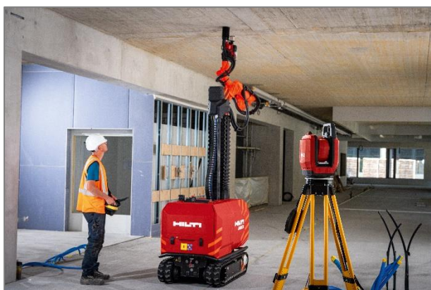
Рис. 1. Строительный робот Hilti Jaibot с поддержкой BIM 1 Fig. 1. Hilti Jaibot construction robot with BIM support
