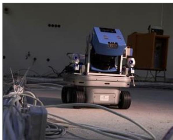
Рис. 3. Автономный мобильный робот Kurt3D 3 Fig. 3. The autonomous mobile robot Kurt3D
