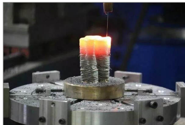
Рис. 9. Технология 3D-печати сверхпрочных металлических деталей из проволоки 7 Fig. 9. 3D printing technology for heavy-duty metal wire parts
