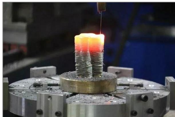
**Рис. 9.** Технология 3D-печати сверхпрочных металлических деталей из проволоки<sup>7</sup>
