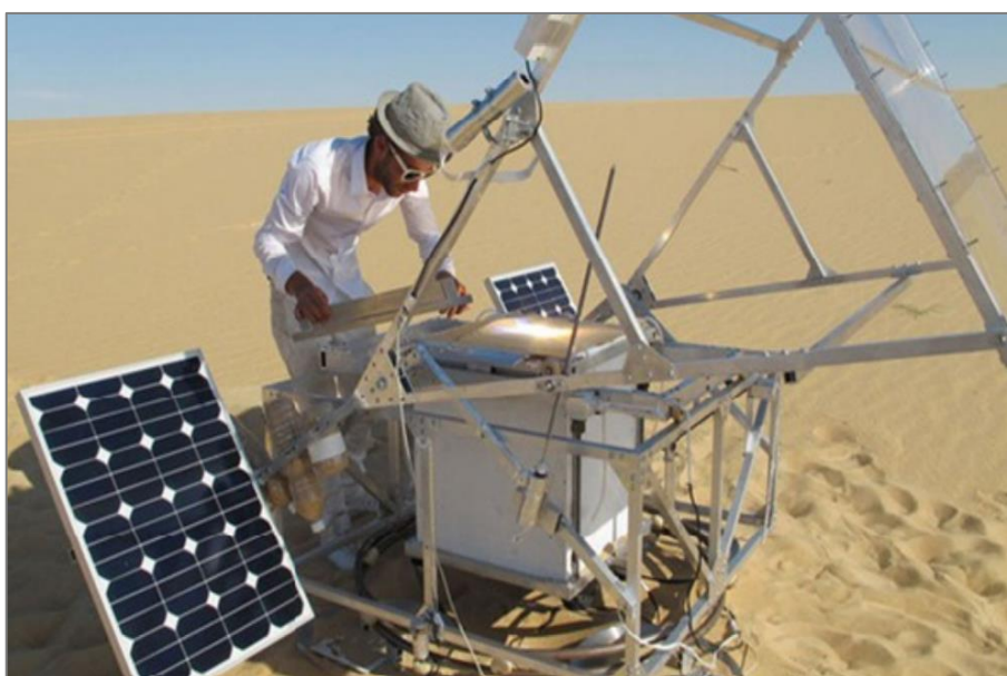
Рис. 2. Установка для реализации метода спекания [3]. Fig. 2. Installation for the implementation of the sintering method
